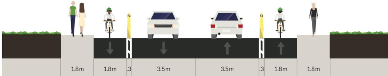
Une bande cyclable est une voie unidirectionnelle ou bidirectionnelle située en bordure de la chaussée, séparée de la circulation automobile par des délimitateurs (*bollards*), un revêtement distinct ou un marquage au sol.
